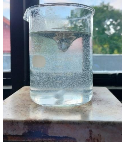
Gambar 18. Pembuatan Suspensi NaCMC 0,5%
