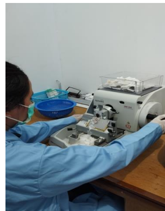
Gambar 28. Organ dipotong dengan ketebalan 5µm
