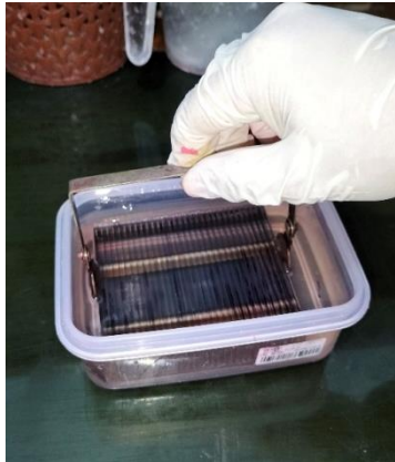
Gambar 31. Direhidrasi menggunakan alkohol bertingkat keatas
