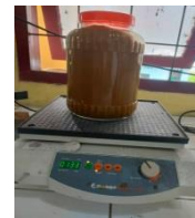
Proses pengadukan sampel setelah ditambahkan ethanol 1 : 5
