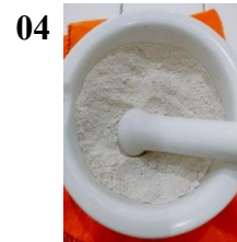
Tepung Cangkang Kerang Hjaiu setelah proses Kalsinasi
