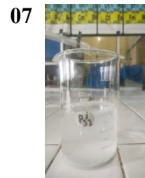
Penambahan Ammonium Sulfat 3,45 % hingga terbentuk endapan putih PCC
