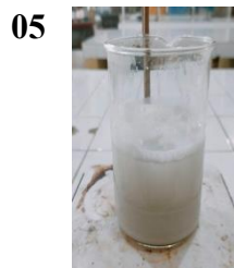
Penambahan aquadest hingga tepung cangkang kerang hijau menjadi suspensi
