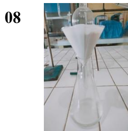
Endapan disaring menggunakan kertas saring whatman
