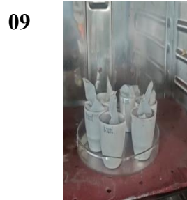
Pengeringan endapan dalam oven suhu 60^{\circ}\text{C} selama 5 jam
