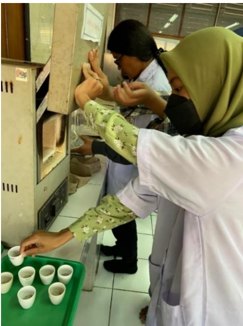
Lampiran 16. Memanaskan sampel sedimen dengan tanur
