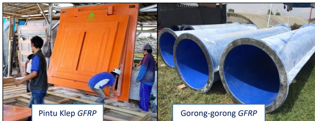
Gambar 19. Contoh produk material *GFRP* untuk digunakan sebagai komponen bangunan air yang dibuat oleh pabrik *GFRP* di Kota Lembang, Provinsi Jawa Barat
