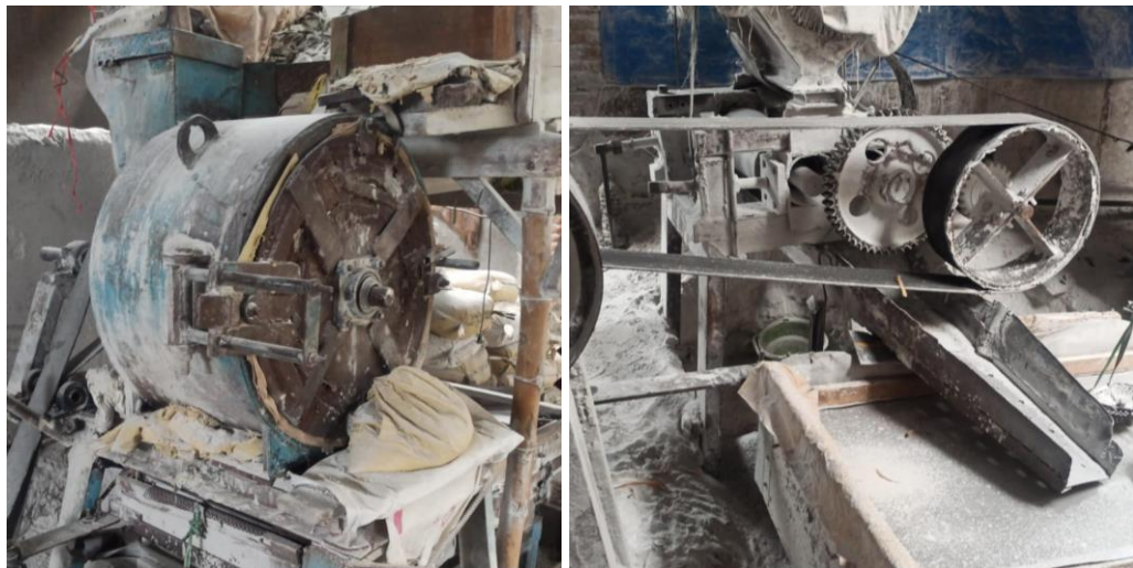
Lampiran 2. Proses pengilingan kaca botol menjadi serbuk kaca
