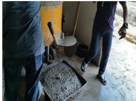
Pengujian slump beton dengan target nilai desain slump yaitu  $20 \pm 2$  cm
