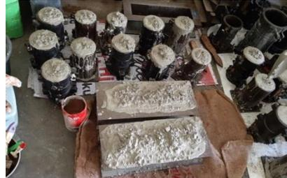
Proses perawatan (*curing*) benda uji beton semua variasi di *curing* menggunakan air pada suhu 20°C selama 28 hari.
