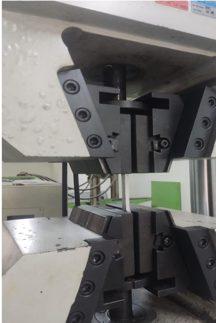
Dokumentasi proses pengujian tarik AL 7072
