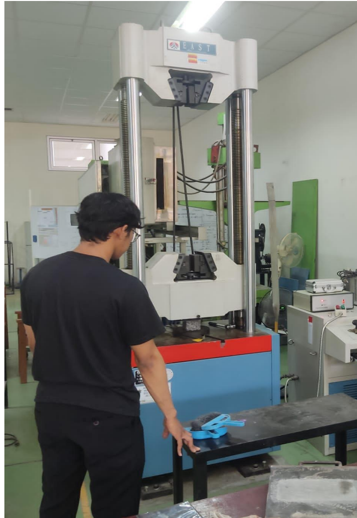
Dokumentasi proses pengujian tekan aluminium foam
