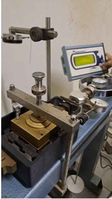
Dokumentasi 2. Pengujian Direct Shear
