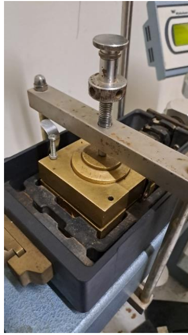
Dokumentasi 2. Pengujian Direct Shear
