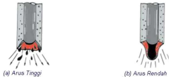
Gambar 2. 8 Pemandahan Logam Cair Sumber : (Wiryosumarto & Harsono, 2000)
