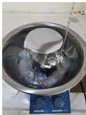
Proses oksida menggunakan \text{H}_2\text{SO}_4 + \text{KMnO}_4
