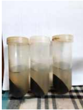
Setelah disentrifugasi pada 10.000 rpm selama 20 menit
