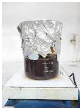
Pengadukan pada suhu 35\text{ }^\circ\text{C} setelah penambahan \text{KMnO}_4
