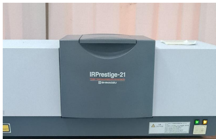
Gambar 20. Analisis SB menggunakan spektrofotometer FTIR (Shimadzu®)
