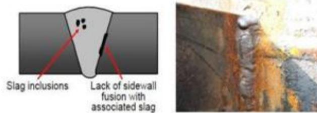
Gambar 2. 32 Cacat Las Slag Inclusion
