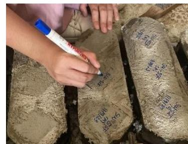
Setelah diberikan label nama sesuai variasi, selanjutnya membuka atau membongkar bekisting/ cetakan mortar, kemudian hasil mortar dikeluarkan dari cetakan. Campuran mortar yang telah dikeluarkan, kemudian dilanjutkan dengan membersihkan bekisting/ cetakan mortar dan direkatkan kembali seperti semula.
