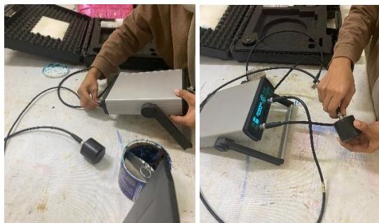
Langkah kedua yaitu mengoles gemuk (gel stempet) pada ujung sampel yang akan diletakkan tranduser, dan mulai pembacaan kecepatan rambat gelombang pada alat, serta mencatat hasil kecepatan rambat gelombang dari alat.
