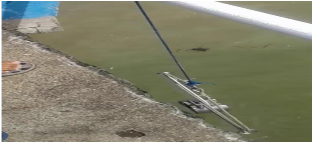
Pengambilan sampel sedimen menggunakan Grab Sampler
