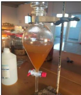
Proses fraksinasi dalam corong pisah untuk memisahkan zat polar dan non polar
