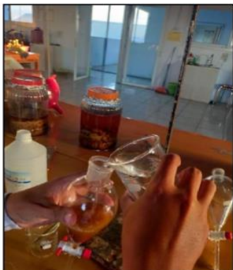
Memasukkan sampel ke dalam corong pisah
