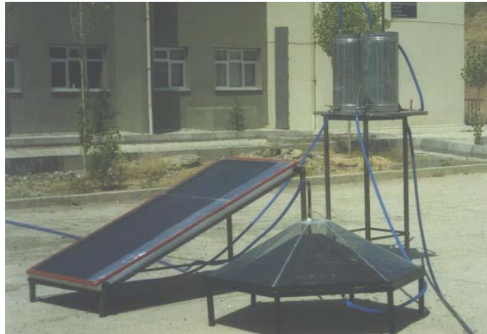
Gambar 8 Perbandingan Kolektor Surya Pipa Spiral Pelat Kerucut dengan Kolektor Pelat Datar
