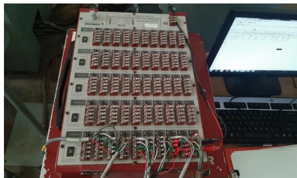
Data Logger dan Komputer Untuk Merekam Hasil Pengujian
