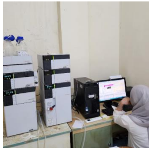
Gambar 27. Pengukuran kadar siklosporin menggunakan HPLC
