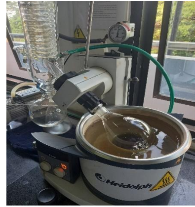
Gambar 25. Proses penguapan pelarut
