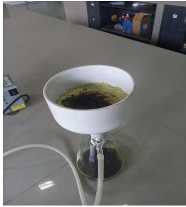
Gambar 24. Proses penyaringan ekstrak
