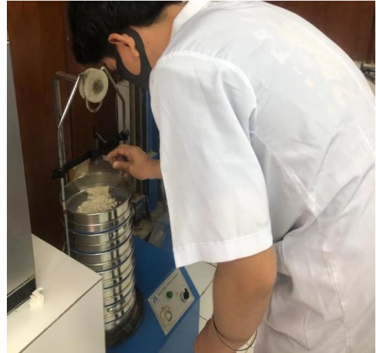
Pengayakan Sampel Sedimen dengan Shieve Shaker
