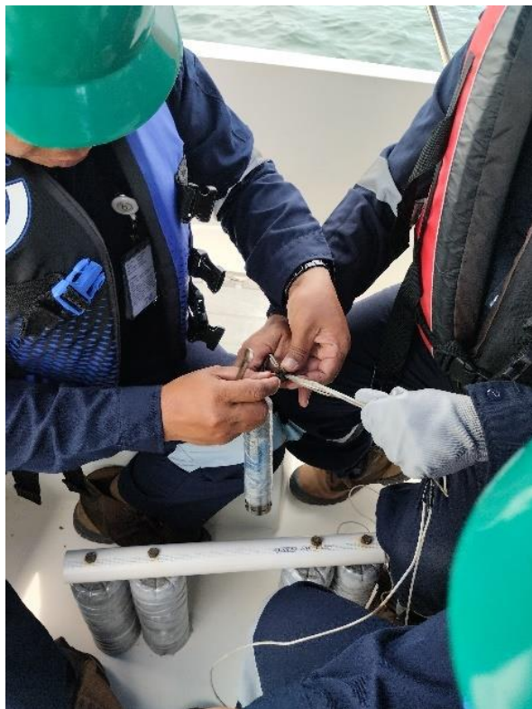
(b) pemasangan pemberat pada tide gauge
