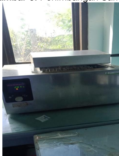
Gambar 10. Pemanasan menggunakan waterbath
