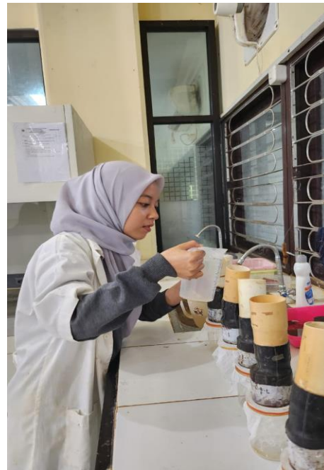
Pengujian Permeabilitas Tanah
