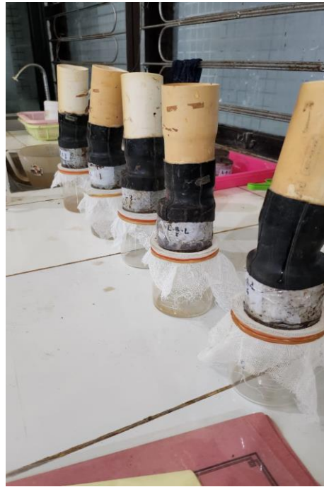
Pengujian Permeabilitas Tanah
