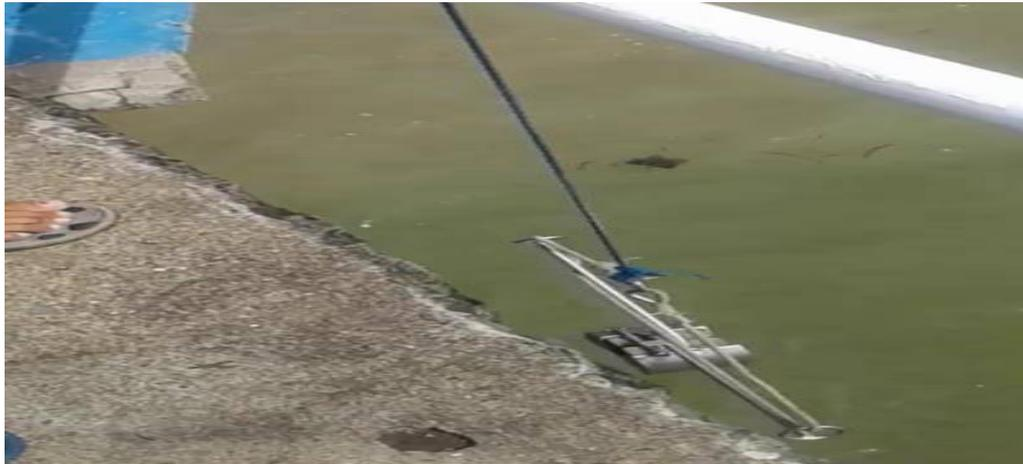
Pengambilan sampel sedimen menggunakan *Grab Sampler*
