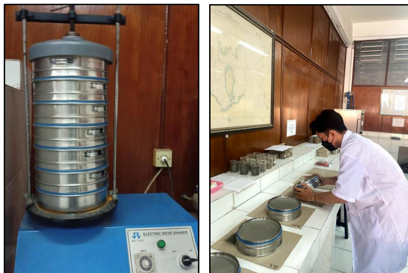
Menyaring Sampel Sedimen menggunakan Sieve Shaker dan Sieve Net
