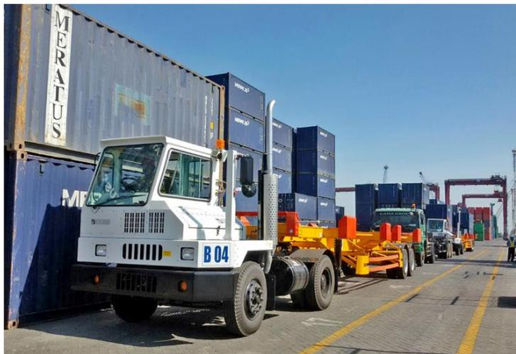
Gambar 2.12. *Head Truck* dan *Chassis*
