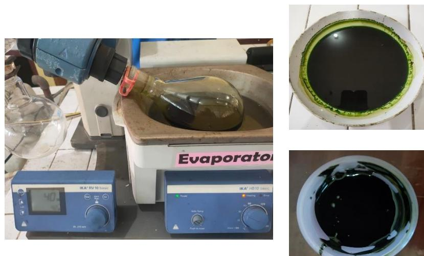
Pemisahan pelarut etanol dengan ekstrak menggunakan alat Rotary Evaporator. Sisa – sisa pelarut diuapkan dalam oven suhu 50°C sampai diperoleh ekstrak berbentuk pasta dengan konsentrasi 100%.
