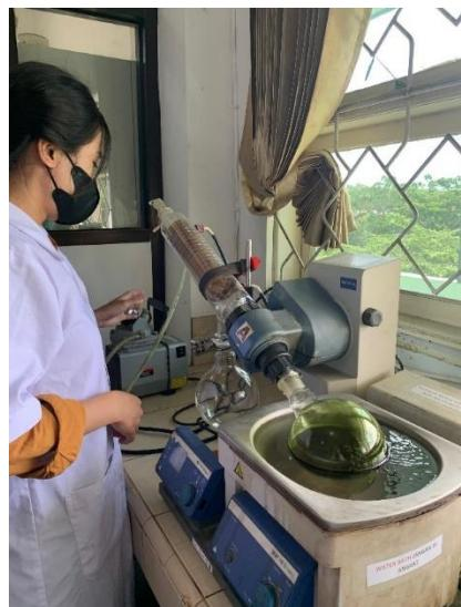
4. Setelah proses evaporasi di dapatkan ekstrak daun jarak pagar yang kental
