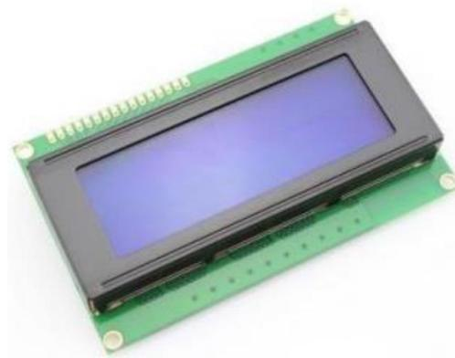
Gambar II. 8 LCD (*Liquid Crystal Display*)
