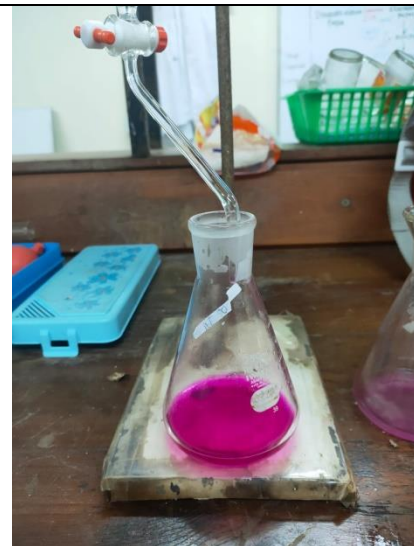
Uji asam asetat pada nata dengan penambahan 100 mL ekstrak kulit buah naga
