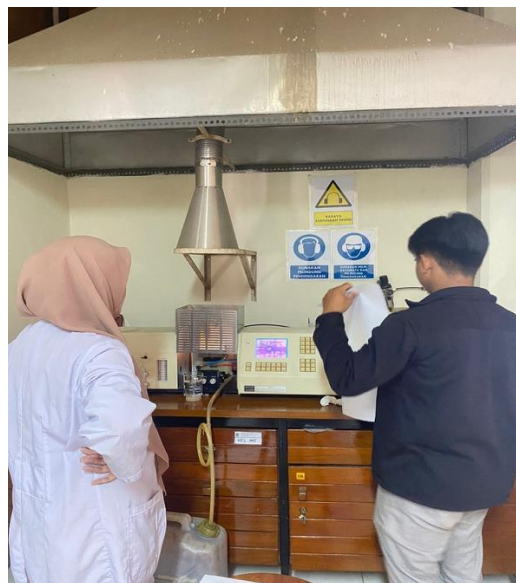
Gambar 11. Proses Injeksi Larutan Standar dan Sampel
