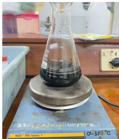
Gambar 12. Proses Adsorpsi variasi waktu kontak Menggunakan magnetic stirrer
