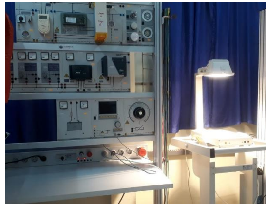
Pengujian Arus-Tegangan DSSC
