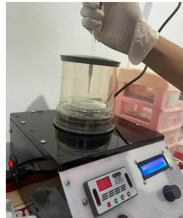
Desposisi pasta \text{TiO}_2 dengan teknik spin coating
