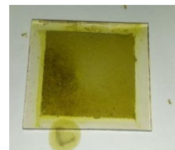
Hasil perendaman kaca dalam dye selama 66 jam
