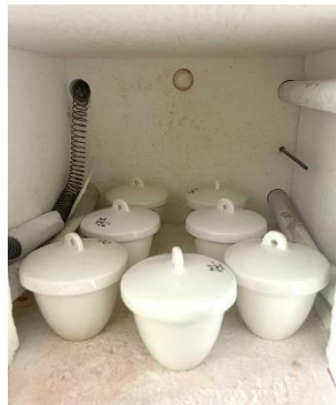
Endapan yang telah dikeringkan dilakukan kalsinasi lebih lanjut
