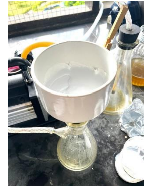
Komposit hidroksiapatit/ \text{SiO}_2 disaring
