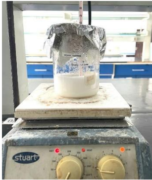
Pengadukan larutan komposit hidroksiapatit/SiO 2 /gelatin
