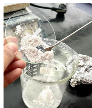
Penambahan komposit hidroksiapatit/ \text{SiO}_2 kedalam gelatin
