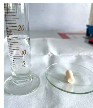
Sisa volume larutan etanol setelah scaffold dikeluarkan (Vc)
