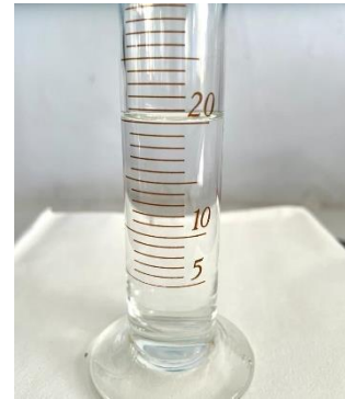
Persiapan larutan etanol untuk uji porositas (Va)
