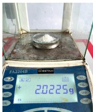
Penimbangan komposit hidroksiapatit/ \text{SiO}_2
