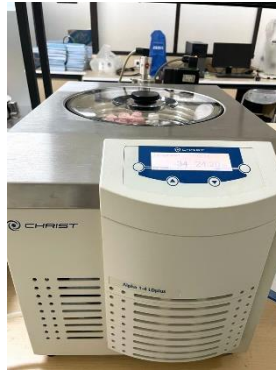
komposit dicetak pada tabung dan dilakukan pembekuan dan pengeringan dengan menggunakan freeze-dryer
