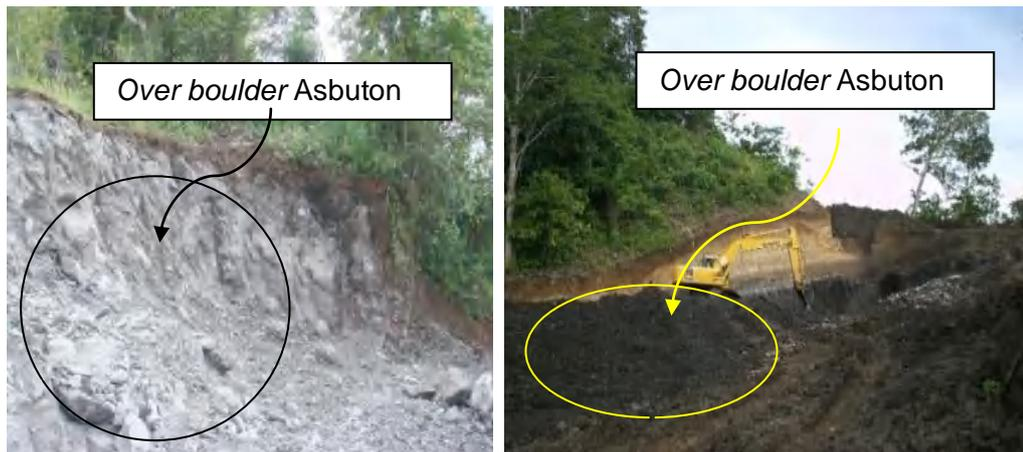
**Gambar 2.3.** *Over boulder* di pertambangan Asbuton
