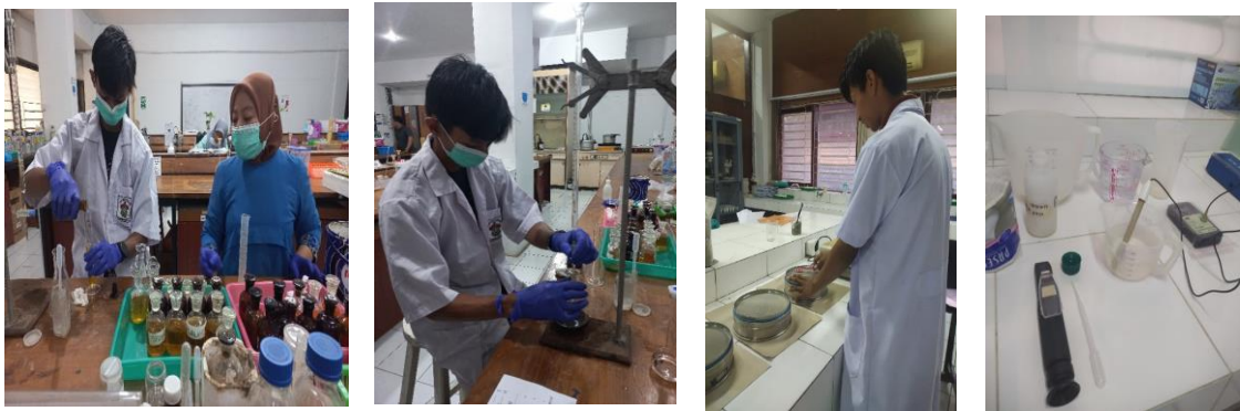
Ket. : Pengukuran DO metode titrasi winkler, pengukuran butir sedimen, pengukuran pH dan Salinitas dilaboratorium.
