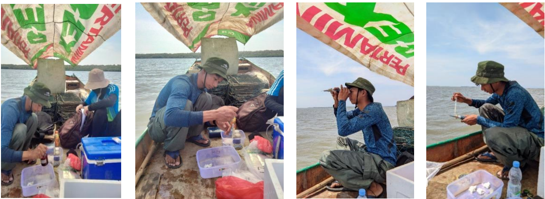
Ket. : Pengambilan sampel perairan, pengikatan DO dengan larutan kimia, pengukuran salinitas
