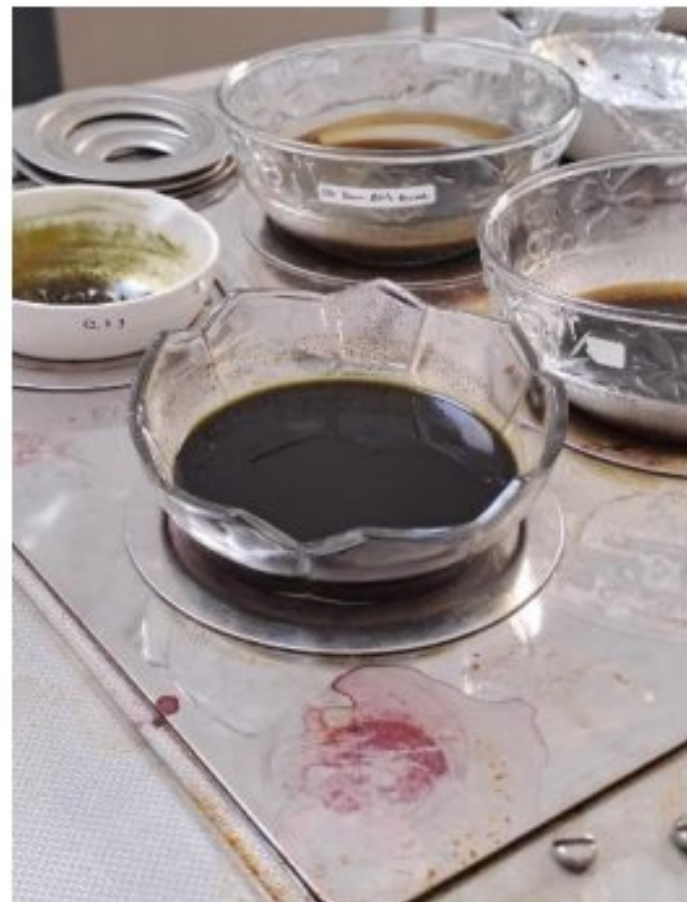
(d) Pengentalan ekstrak dengan waterbath
