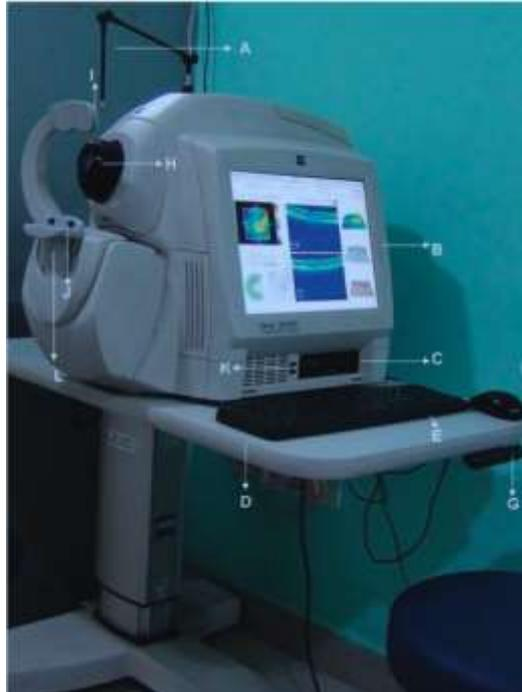
Gambar 20. Bagian mesin OCT. (A). Fiksator eksternal (B). Monitor video terintegrasi (C). CD-drive atau USB port (D). Meja (E). Keyboard (F). mouse (G). Tuas untuk adjust tinggi-rendah meja (H). Apertura *Imaging* (I). tempat duduk kepala (J) Tempat duduk dagu (K). Tombol nyala. (Agarwal, 2015)
