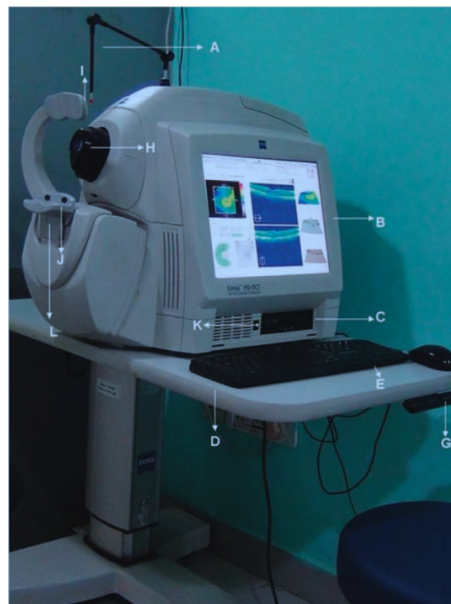
Gambar 12. Bagian mesin OCT. (A). Fiksator eksternal (B). Monitor video terintegrasi (C). CD-drive atau USB port (D). Meja (E). Keyboard (F). mouse (G). Tuas untuk adjust tinggi-rendah meja (H). Apertura Imaging (I). tempat duduk kepala (J) Tempat duduk dagu (K). Tombol nyala (Agarwal A et al, 2015).
