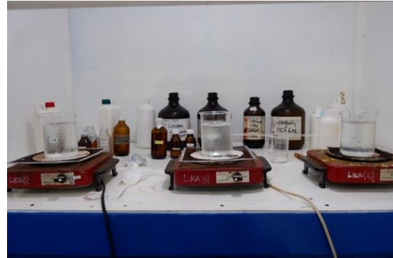
Proses destruksi dengan penambahan \text{HNO}_3
