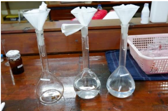
Proses penyaringan setelah destruksi
