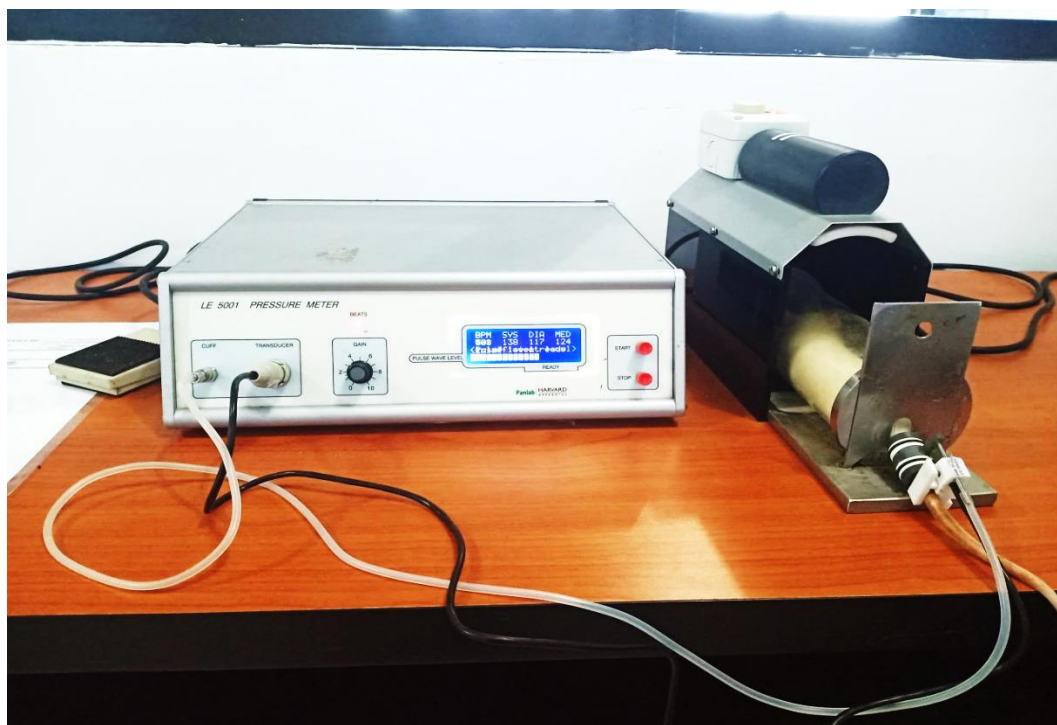
Gambar 29. Seperangkat Alat Tensi Tikus tail-cuff method dari PANLAB Harvard Apparatus Tipe 5001
