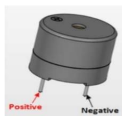
Gambar 2.10 Konfigurasi pin buzzer [46].
