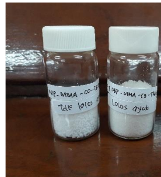
Polimer hasil sintesis MIP_DBP_MMA-co-TRIM dan NIP_MMA-co-TRIM disimpan
