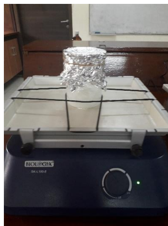
Proses pencucian polimer dengan aseton, metanol, dan akuades agar bersih dari pengotor
