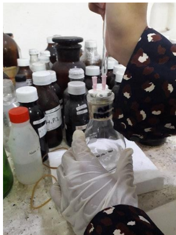
Pengaliran gas nitrogen untuk menghilangkan gas oksigen
