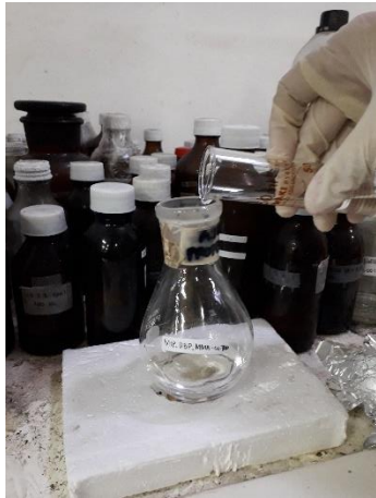
Proses pencampuran bahan dan prapolimerisasi
