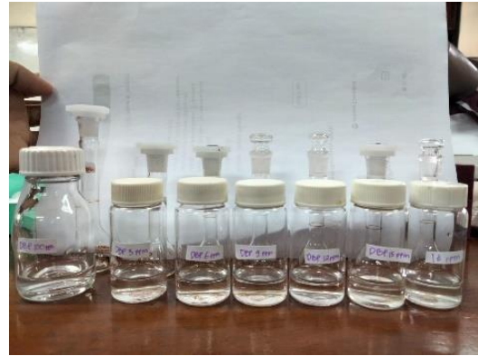
Pembuatan deret standar DBP
