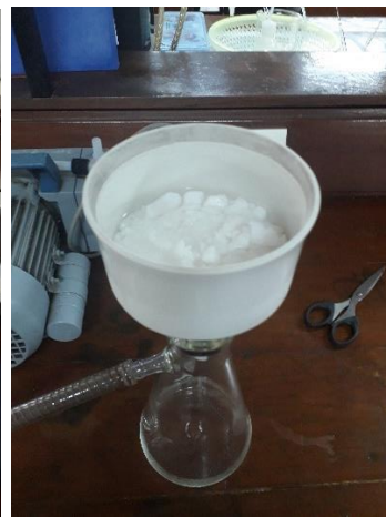
Proses pencucian polimer dengan aseton, metanol, dan akuades agar bersih dari pengotor
