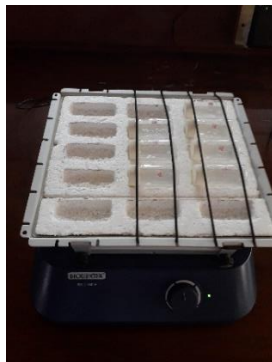
Pengocokan dengan alat shaker untuk pengaruh waktu dan konsentrasi terhadap adsorpsi DBP
