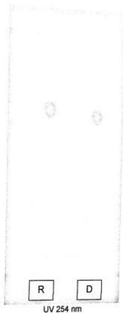
Gambar 2. Hasil kromatografi lapis tipis sampel minuman dan zat warna pembanding
