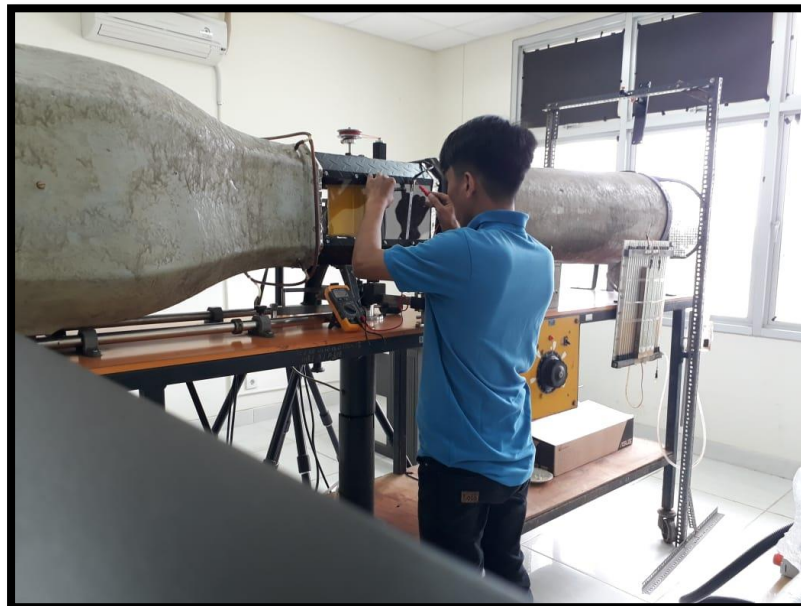
Gambar D.2 Pemasangan turbin
