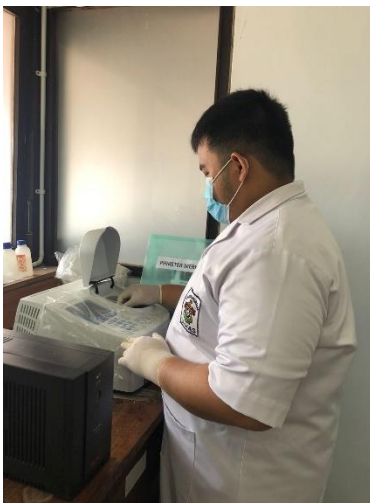
Gambar 8.8. Pengukuran Absorbansi Menggunakan Spektrofotometer
