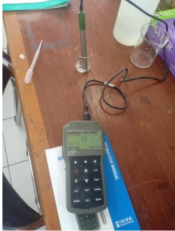
Gambar 8.6. Pengukuran pH Reagen dengan pH meter HANNA
