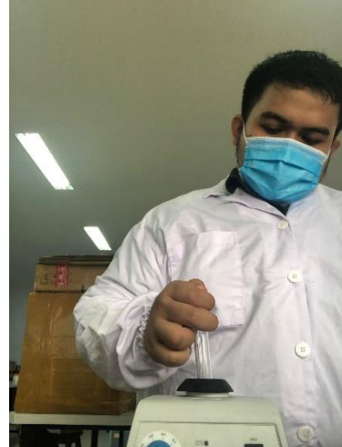
Gambar 8.7. Pencampuran Larutan A dengan Variabel Independen di dalam tabung reaksi menggunakan vibrator
