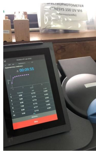
Gambar 8.9. Tampilan Proses Pengukuran Absorbansi Menggunakan Spektrofotometer
