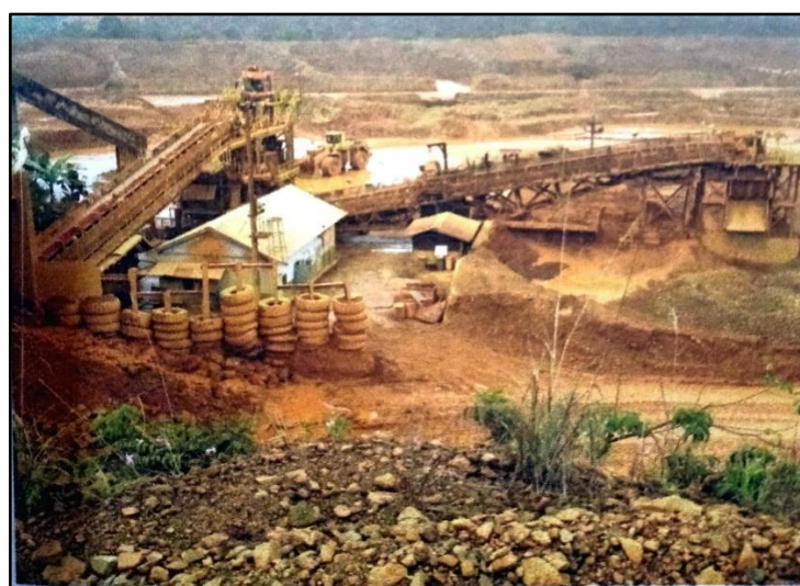
Gambar 15 Area Fasilitas stasiun penyarangan ( Screening Section ) Pabrik pengolahan biji laterit menjadi nikel matte di Sorowako (Irwandy Arif, 2015)
