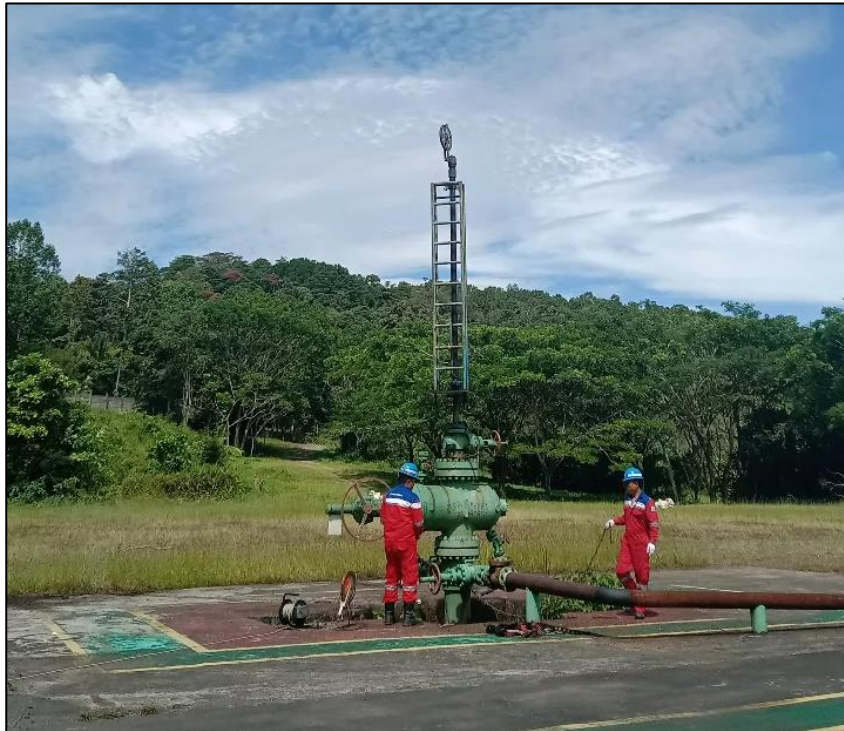
Gambar 2. 14. Proses pengukuran data Pressure-Temperature-Spinner Survey (PTS) daerah penelitian.
