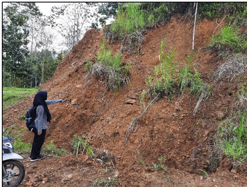
Gambar 2.6 Kenampakan debris slide difoto dengan arah N 82°E dekat stasiun 35
