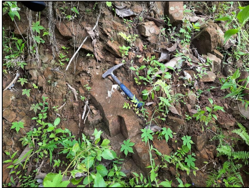
Gambar 2.3 Pelapukan kimia berupa perubahan warna menjadi merah kecoklatan pada litologi basal pada stasiun 81
