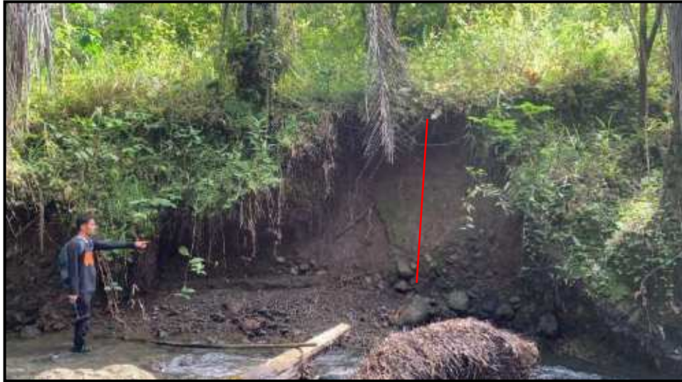
Gambar 2. 9 Residual soil pada litologi basal dengan warna coklat kemerahan dan tebal 2,5-3 meter difoto ke arah N38°E
