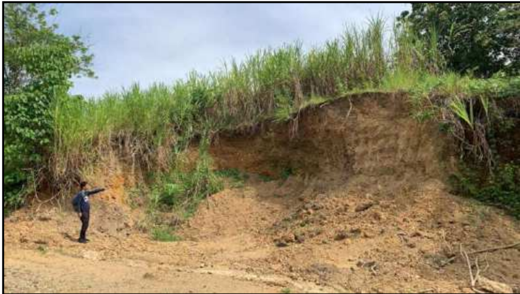
Gambar 2. 13 Gerakan tanah berupa debris slide pada daerah Salo Kapele dengan arah foto N 168°E
