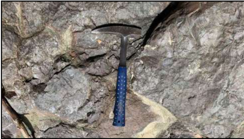
Gambar 2. 2 Pelapukan kimia pada litologi basal stasiun 56 difoto ke arah N72°E
